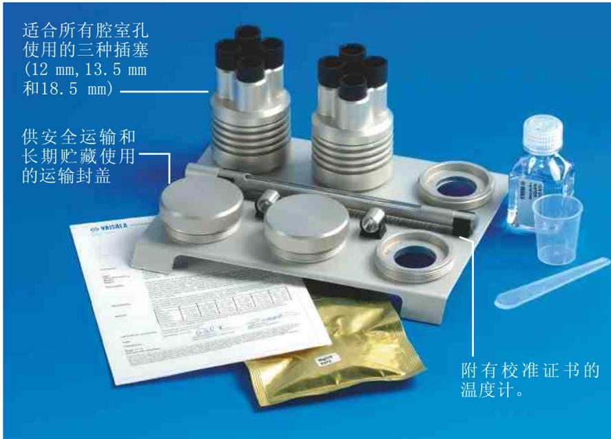
除实验室使用外，维萨拉湿度校准器HMK15也适用于湿度探头和变送器的现场抽检。
